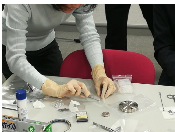
図1. 実習の風景1. 熱分析用のアルミ製パンへ粉体試料を詰めてペレット状に固めてマウントする様子.
