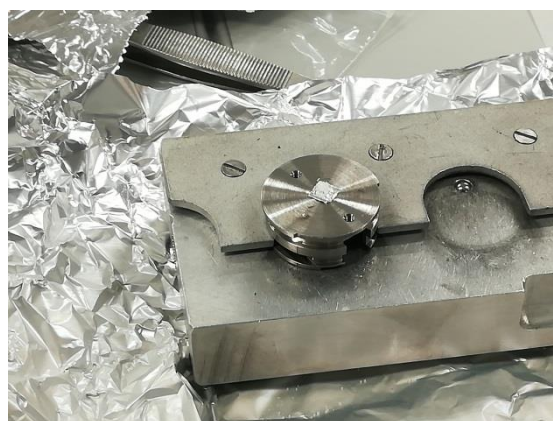
図2. 実習の風景2. インジウム箔へ試料をマウントする様子.
